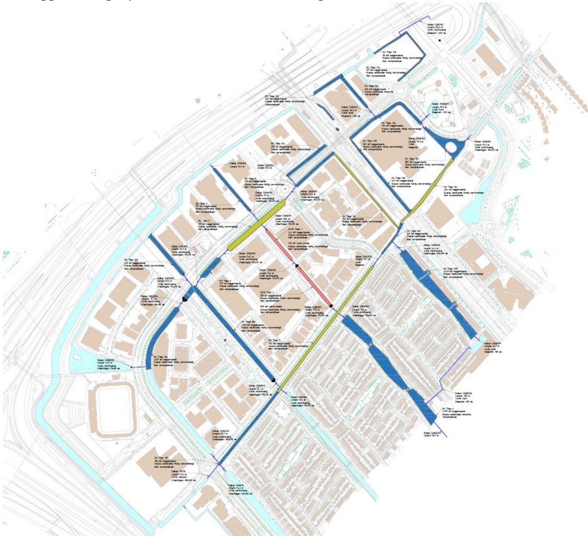
Figuur 5.2-1: Uitvoeringsscope (rode watergangen saneren, gele watergangen hydraulisch baggeren, donkerblauwe watergangen mechanisch baggeren, lichtblauwe watergangen vallen buiten de scope)
