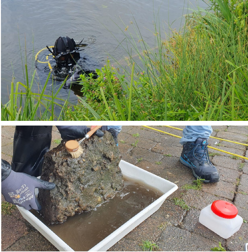
Foto 2.2 Inzet beroepsduiker voor de bemonstering van de onderkant van drijvende structuren en het afschrappen van een steen uit het monsterpunt van de kademuur in de Laakhaven.
